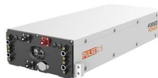
Le pulse 2.5 'marine' est équipé par ailleurs de cellules LTO Toshiba avec un système de refroidissement liquide qui lui permet d'effectuer 15 000 cycles sur plus de 12 ans.
